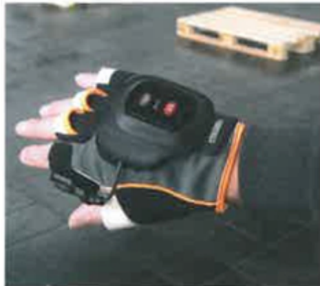
Zentrales Element des Crown Fernbedienungssystems QuickPick Remote ist der patentgeschützte intelligente Handschuh.
