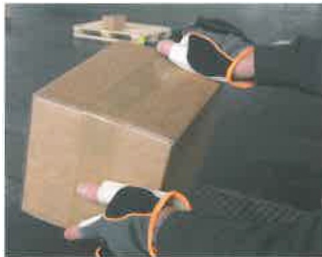
Selbst wenn beide Hände für die Entnahme benötigt werden, kann man die Fahrtaste betätigen, sodass sich der Stapler an genau die richtige Stelle bewegt und die Gehdistanz minimiert wird.
