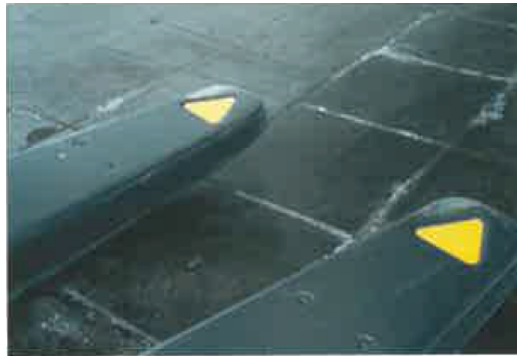
Durch die deutlich sichtbaren Markierungen sind die Gabelspitzen des GPC 3000 nicht zu übersehen.
