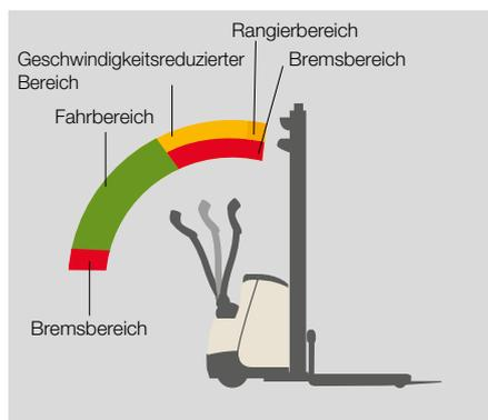
Beim Bewegen der Deichsel aus dem Fahrbereich in den **geschwindigkeitsreduzierten Bereich** wird die Fahrgeschwindigkeit in Gabelrichtung automatisch auf 1,5 km/h reduziert, ohne dass angehalten werden muss oder ein Bedienerkommando nötig ist.
