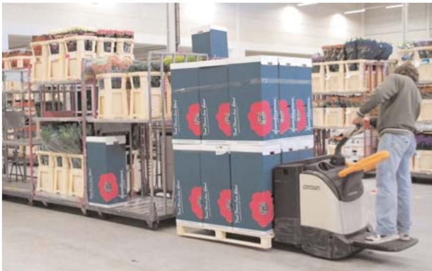
„Unsere Fahrer schätzen die Seitenbügel beim neuen WT 3000. Man kann sie schnell hochklappen und vom Fahrzeug absteigen, ohne das Fahrzeug umrunden zu müssen“, sagt Boogards. Dank der QuickExit Seitenbügel sparen die Fahrer bei jedem Absteigen zwei Schritte.
