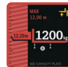
**Rojo:** la carga supera la capacidad o está por encima del límite de altura de elevación.
