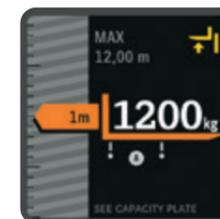
**Gris:** la carga está por debajo de la capacidad y del límite de altura de elevación.
