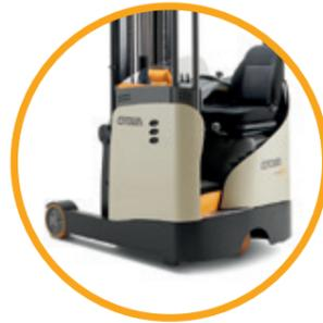
**Soportes de carga estrechos:** admiten cargas de hasta 1000 mm de anchura sin aumentar el ancho total de la carretilla.
