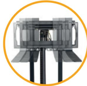
**5ª función hidráulica:** opción para trabajar con implementos, como posicionadores de horquillas con desplazamiento lateral o pinzas, para satisfacer los requisitos de aplicaciones específicas.
