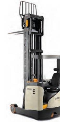
Serie ESR 1260 Carretilla retráctil de alto rendimiento Capacidad máxima de la carretilla: 2000 kg Altura máxima de elevación: 14 205 mm Disponible con: cabina para aplicaciones frigoríficas
