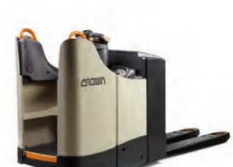
Serie WT 3000 Transpalette con plataforma fija y acceso posterior Capacidad máxima de la carretilla: 2500 kg
