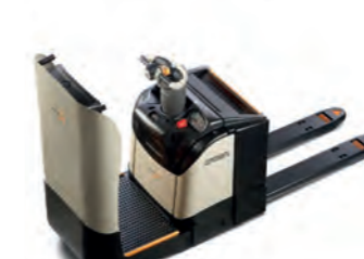
Serie WT 3000 Transpalette con plataforma fija y acceso lateral Capacidad máxima de la carretilla: 2500 kg
