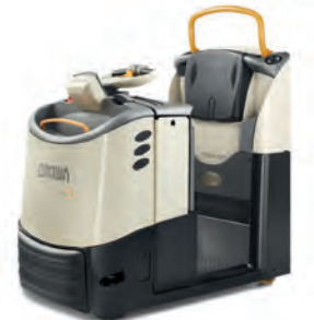
Serie TC 3000 Tractor de arrastre Capacidad de arrastre: 3000 kg
