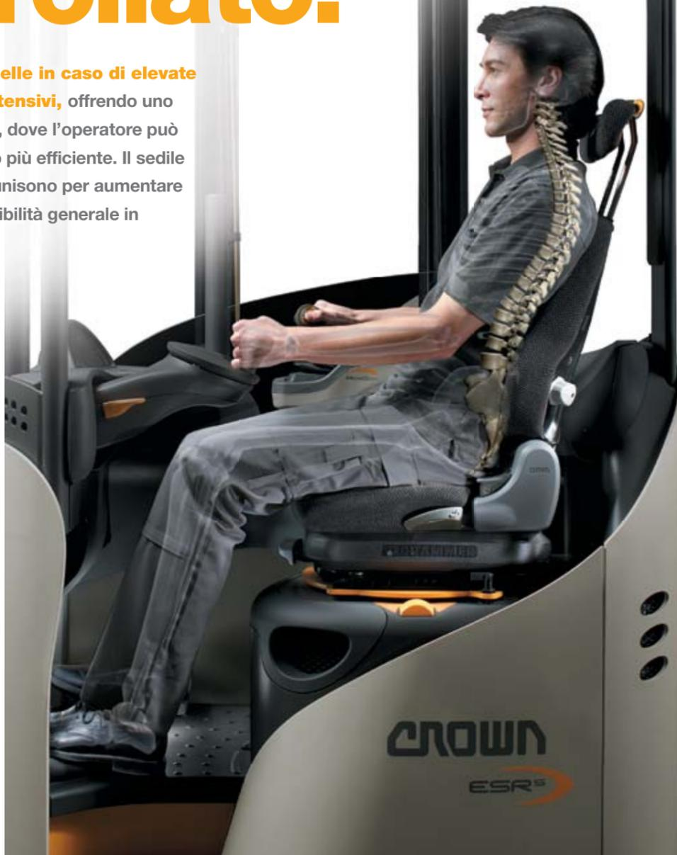
Il sedile MoveSeat™ gira di 10° dalla posizione neutra per migliorare la visibilità durante la marcia con corpo macchina avanti. Durante la marcia con forche avanti, il sedile gira di 20° dalla posizione neutra, aumentando la visibilità in avanti e verso l'alto sulle forche.
