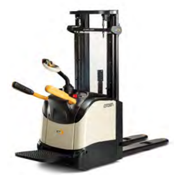
ET 4000-serie Meerijstapelaar met uitklapbaar platform met/zonder initiaalheffing Max. truckcapaciteit: 1600 kg Max. hefhoogte: 5400 mm
