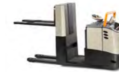
GPC 3000-serie Laagheffende orderpicker met hulpvorken Max. truckcapaciteit: 1200 kg Max. hefhoogte: 960 mm Verkrijgbaar met: QuickPick Remote
