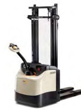
ES 4000-serie Meeloopstapelaar met/zonder initiaalheffing Max. truckcapaciteit: 1600 kg Max. hefhoogte: 5400 mm
