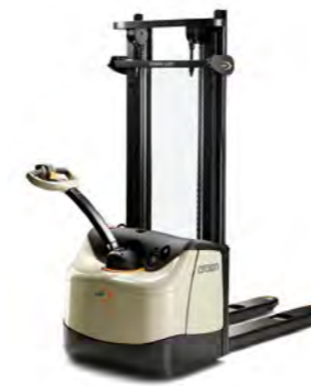
WF 3200-serie Meeloopstapelaar Max. truckcapaciteit: 1200 kg Max. hefhoogte: 4400 mm
