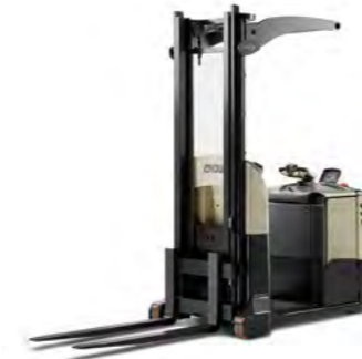
MPC 3000-serie Orderpicker met mast Max. truckcapaciteit: 1200 kg Max. hefhoogte: 4300 mm Verkrijgbaar met: QuickPick Remote
