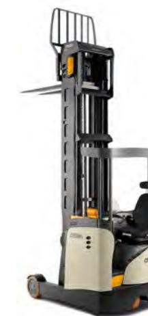
ESR 1260-serie Heavy-duty reachtruck Max. truckcapaciteit: 2000 kg Max. hefhoogte: 14.205 mm Verkrijgbaar met: vrieshuiscabine
