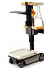
WAV 60-serie Work Assist Vehicle Capaciteit laadplateau: 90 kg Capaciteit laadvloer: 150 kg
