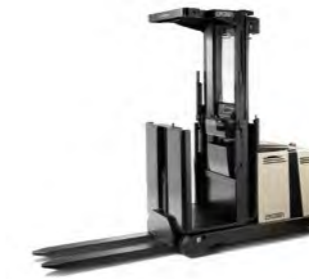
LP 3500-serie Middelhoogheffende orderpicker met hulpvorken Max. truckcapaciteit: 1000 kg Max. vorkhefhoogte: 2440 mm
