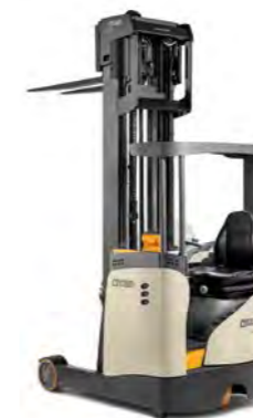
ESR 1240-serie Reachtruck Max. truckcapaciteit: 2000 kg Max. hefhoogte: 14.025 mm Verkrijgbaar met: vrieshuiscabine
