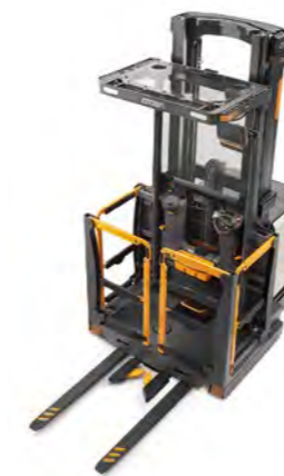
SP 1500-serie Hoogheffende orderpicker met vaste vork Max. truckcapaciteit: 1250 kg Max. vorkhefhoogte: 10.210 mm Max. platformhefhoogte: 10.380 mm
