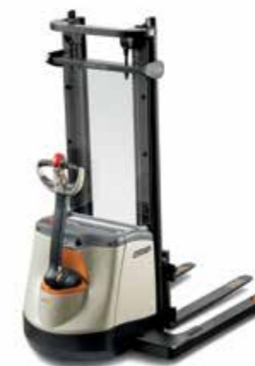
Série SX 3000 Empilhadeira patolada Walkie Capacidade de carga: 1.500 kg Altura de elevação: 2.400 a 4.250 mm
