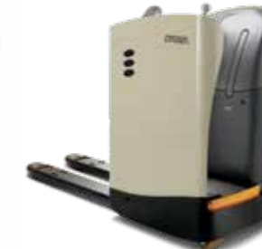
Série RT 4000 Transpaleteira com operador embarcado Capacidade de carga: 2.000 kg Garfos: comprimento duplo disponível
