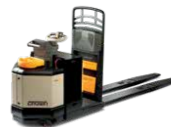
Série PC 4500 Transpaleteira com controle central Capacidade de carga: 2.700 a 3.600 kg Garfos: comprimentos duplos e triplos disponíveis
