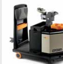
Série TR 4500 Rebocador Capacidade de carga rolante: 4.500 kg
