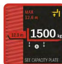
**Rojo:** la carga supera el límite de capacidad o de altura de elevación.
