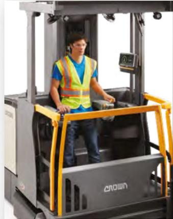
**Las tareas de conductor de pie** se llevan a cabo con comodidad gracias al asiento abatible y a los mandos de control regulables a la altura del operario.
