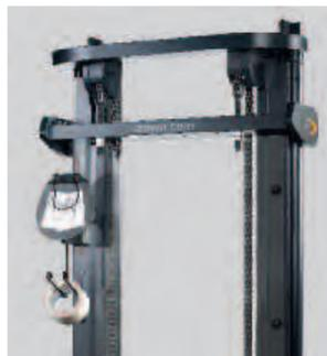
**Аксессуары Work Assist™:** крюк и планшет с зажимом для удобного ведения записей, а также крепления документов, сканирующего устройства и т. п.; вентилятор с регулируемым положением.
