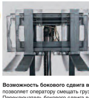
**Возможность бокового сдвига вилок со встроенным управлением:** позволяет оператору смещать груз влево и вправо до 100 мм. Переключатель бокового сдвига встроен в рукоятку Crown X10 (только в серии SX).
