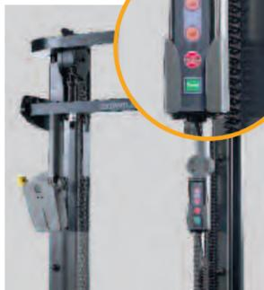
**Дистанционное управление подъемом и опусканием:** дает оператору возможность контролировать функции подъема и опускания при использовании электроштабелера в качестве вспомогательного подъемного устройства.
