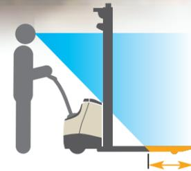
**Наклонный низкопрофильный моторный отсек и особая конструкция мачты** в серии электроштабелеров от компании Crown обеспечивают превосходный обзор концов вилок (обычно 50 процентов общей длины вилок).
