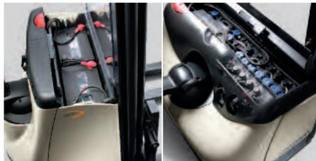
**Разнообразные опции батареи:** данные опции включают варианты батарей до 192 А-ч, не требующих обслуживания, и промышленные батареи с жидкостными элементами до 180 А-ч (показаны с дополнительной центральной системой поддержания уровня жидкости).
