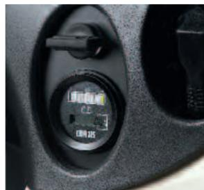
**Индикатор разрядки батареи:** имеет функцию блокировки подъема при недостаточном заряде и встроенный счетчик мото-часов.
