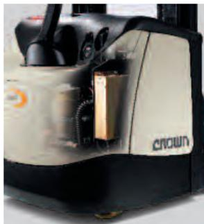
**Встроенное зарядное устройство:** мощное 30-амперное высокочастотное зарядное устройство является стандартным для всех моделей.
