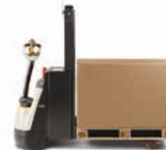
Xe nâng pallet tải trọng 2,0 t Chiều cao nâng: 120 mm
