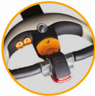
Tay cầm điều khiển X10 bằng nhôm đúc áp suất góp phần tạo nên thiết kế bền bỉ và đảm bảo sắp xếp pallet một cách trơn tru, chính xác với khả năng nâng và hạ pallet tương ứng.
