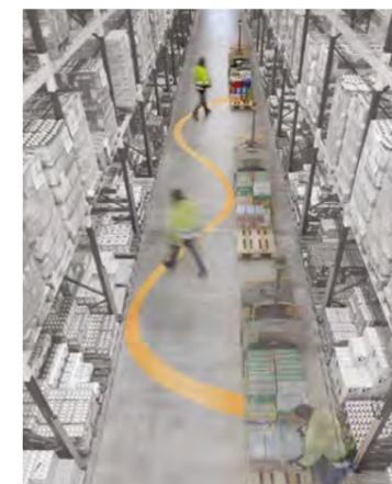
Die **QuickPick Remote**-Kommissioniertechnologie für Niederhubkommissionierung nutzt Drahtlostechnik, um den Stapler ferngesteuert zu bewegen. Da der Bediener seltener auf- und absteigen muss, trägt die Funktion zur Sicherheit bei und verringert die Ermüdung des Bedieners. Weil pro Kommissionierung bis zu fünf Sekunden eingespart werden, ergibt sich eine höhere Produktivität.
