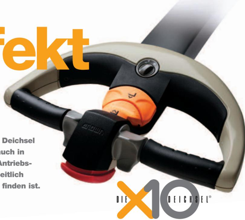
**Sicherheit geht vor: Dank der mittig angebrachten Deichsel befindet sich der Bediener sowohl in Rechts- als auch in Linkskurven stets in einem sicheren Abstand zur Antriebseinheit. Eine herausragende Eigenschaft, die bei seitlich angeordneten Deichseln der Mitbewerber nicht zu finden ist.**
