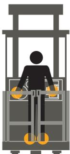
Die vier soliden Kontaktpunkte zwischen Bediener und Stapler mit dem rechts angeordneten, fest montierten Fahrtrichtungs-Drehgriff sorgen für mehr Standsicherheit in jeder Höhe.
