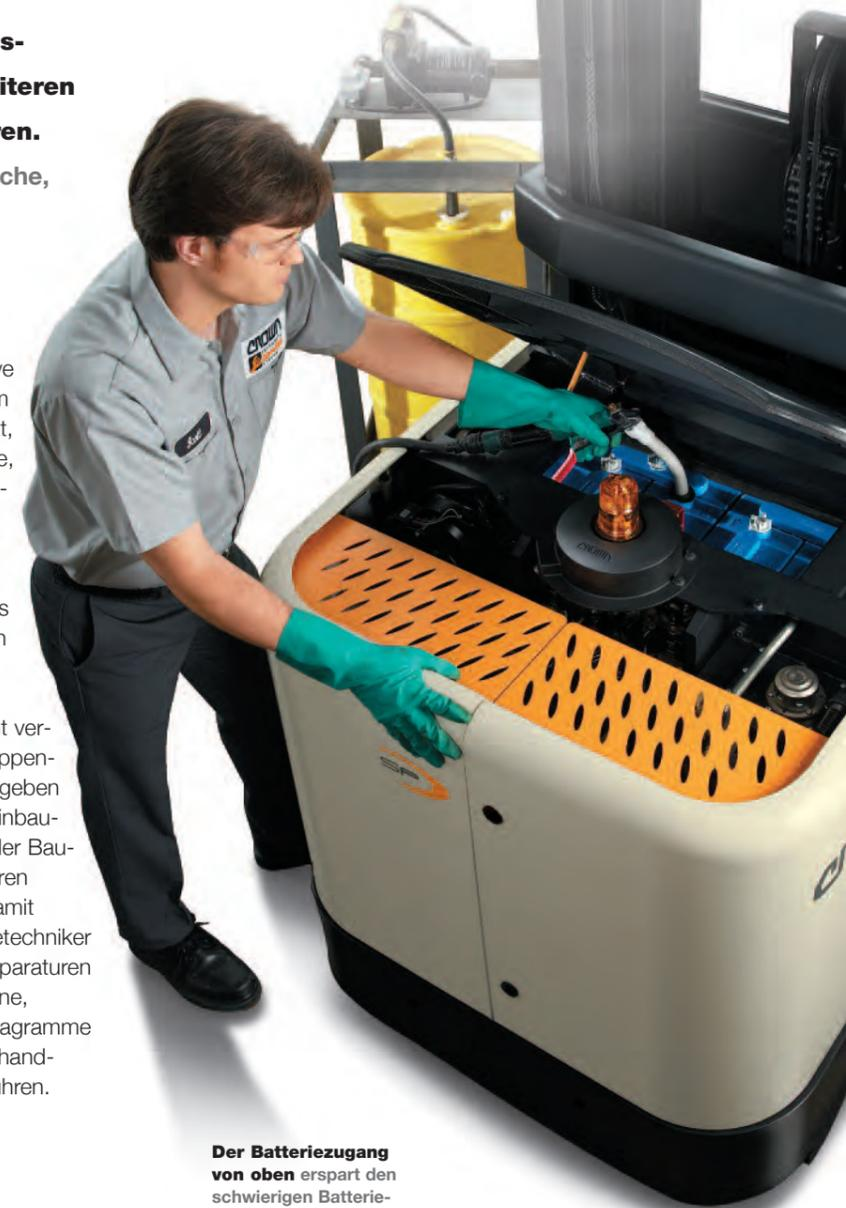
Der Batteriezugang von oben erspart den schwierigen Batterieausbau zum Nachfüllen von Wasser, zum Überprüfen des Elektrolytgehalts, zur Messung der Spannung und zur Durchführung weiterer Routinewartungsarbeiten.
