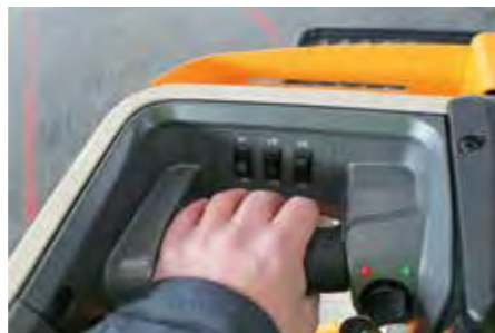
04 Mit der linken Hand wird gelenkt, die Ladeplattform eingestellt sowie der Schildkrötenmodus und die Beleuchtung bedient
