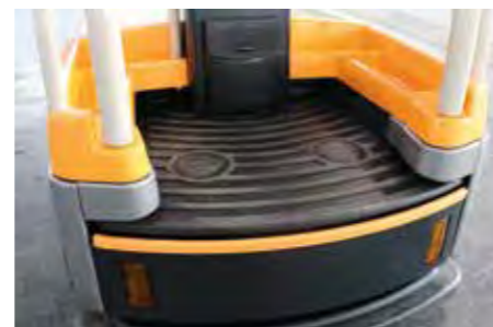
05 Die Arbeitsplattform gewährt einen sicheren Stand – vor dem Start müssen die runden Markierungen getreten werden
