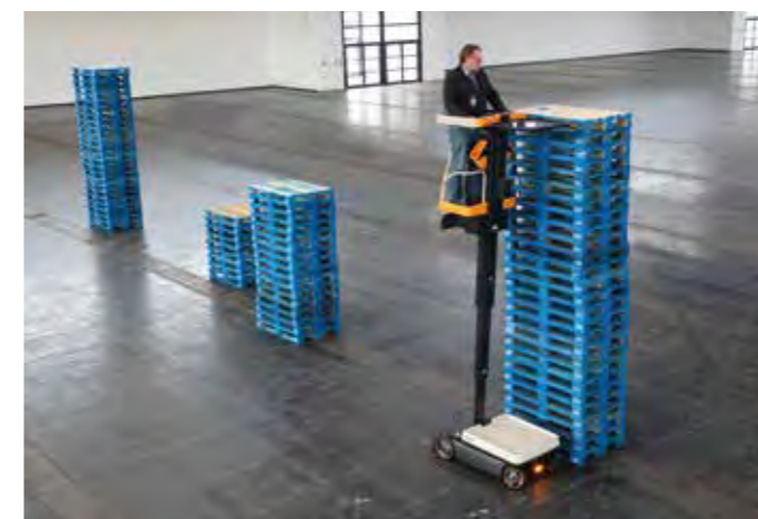
01 Die Arbeitsplattform lässt sich bis in eine Höhe von 2 995 mm hydraulisch anheben
