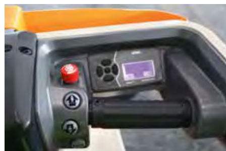
03 Auf der rechten Seite des Cockpits befindet sich die Steuerung für die Fahrgeschwindigkeit und Arbeitsplattform
