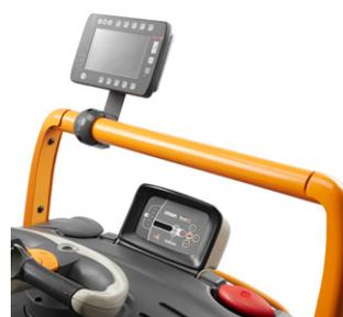
Vordere Befestigungsstange für Work Assist Zubehör mit integrierter Kabelführung
