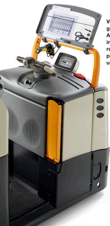
Vordere Befestigungsstange für Work Assist Zubehör mit integrierter Kabelführung, großem, transparentem Klemmbrett und Scannerhalterung
