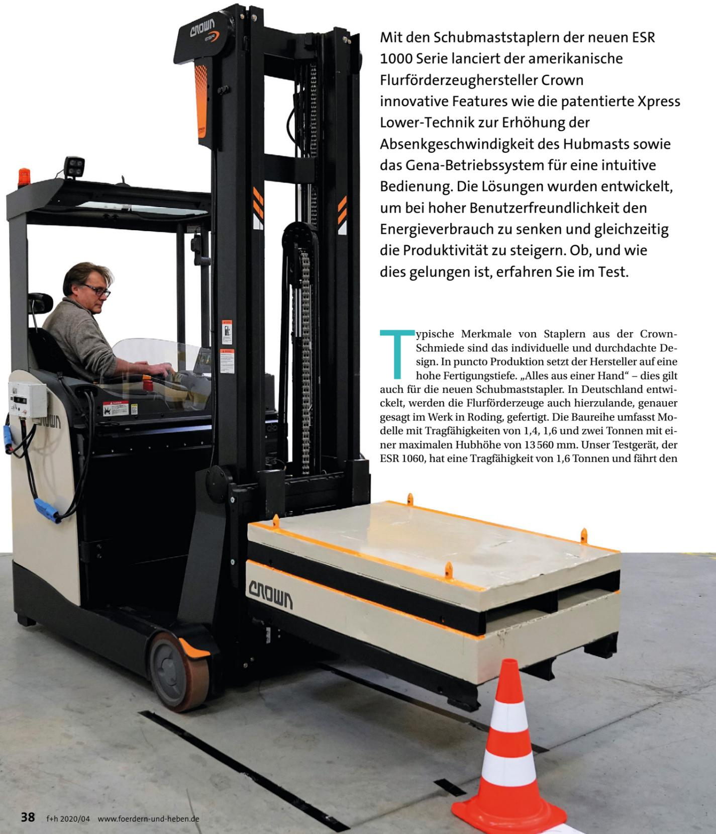
Mit den Schubmaststaplern der neuen ESR 1000 Serie lanciert der amerikanische Flurförderzeughersteller Crown innovative Features wie die patentierte Xpress Lower-Technik zur Erhöhung der Absenkgeschwindigkeit des Hubmasts sowie das Gena-Betriebssystem für eine intuitive Bedienung. Die Lösungen wurden entwickelt, um bei hoher Benutzerfreundlichkeit den Energieverbrauch zu senken und gleichzeitig die Produktivität zu steigern. Ob, und wie dies gelungen ist, erfahren Sie im Test.
