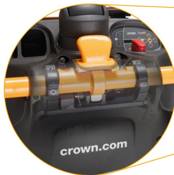
**Die stabilen Seitenbügel bestehen aus einem 50 mm starken Stahlrohr und einem massiven Befestigungssystem in C-Profilform.**
