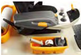
Das magnetische Ablagefach für Klein- und Ersatzteile lässt sich an verschiedenen Stellen am Stapler anbringen. Auch das Work Assist™ Zubehör von Crown kann leicht zugänglich an den Schutzdachholmen befestigt werden.
