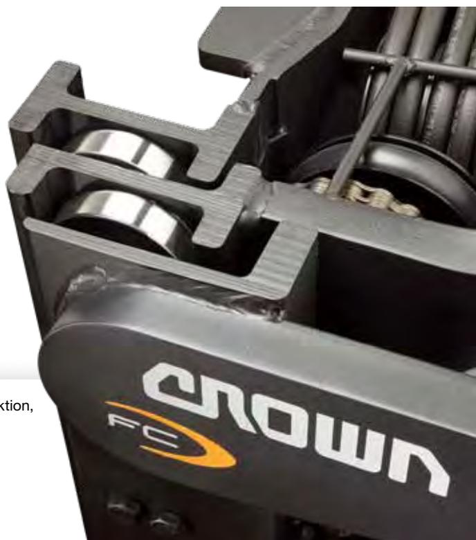
Für den **festen Stand der Masten** sorgt die Doppel-T-Profilkonstruktion, die Längs-, Seiten- und Torsionsbiegekräften gut standhält.
