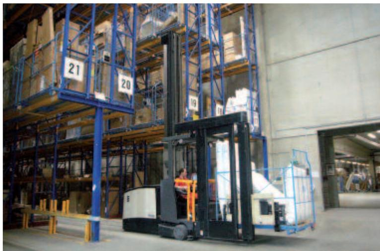
Der TSP 6000 ist ein ‚Man-up‘-Stapler, d.h. der Bediener befindet sich immer auf gleicher Höhe mit der Last. Dadurch kann er in bis zu 12 Meter Höhe punktgenau arbeiten und Schäden an Paletten oder am Regal werden vermieden. Ein weiterer wichtiger Faktor beim Arbeiten in großen Höhen ist das Sicherheitsgefühl des Bedieners. Da bietet die mittige, geschlossene Mastkonstruktion von Crown – einzigartig im Stapler-Sektor – eine unver-
