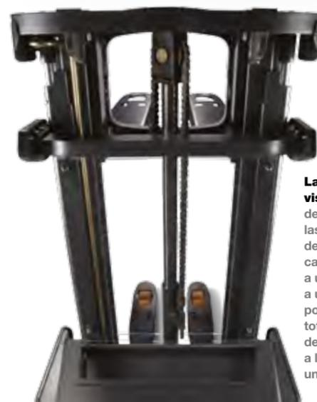
La excelente visibilidad de la punta de las horquillas y de las patas de carga se debe a un mástil y a un tablero portahorquillas totalmente despejados, y a la compacta unidad de tracción.
