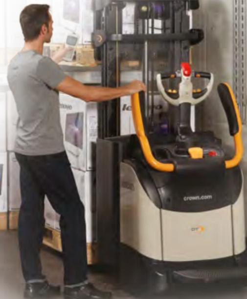
La función de salida rápida de Crown (pendiente de patente) permite levantar -sin esfuerzos- las protecciones laterales, para acceder o salir de la plataforma ahorrando tiempo y distancia.
