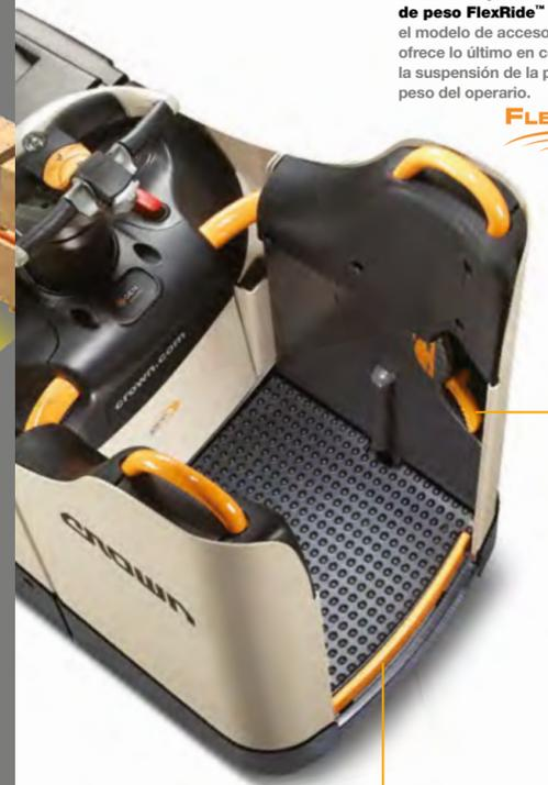
**La barra de seguridad patentada** de los modelos de plataforma fija detiene la máquina cuando el operario saca el pie del perímetro de seguridad de la plataforma.
