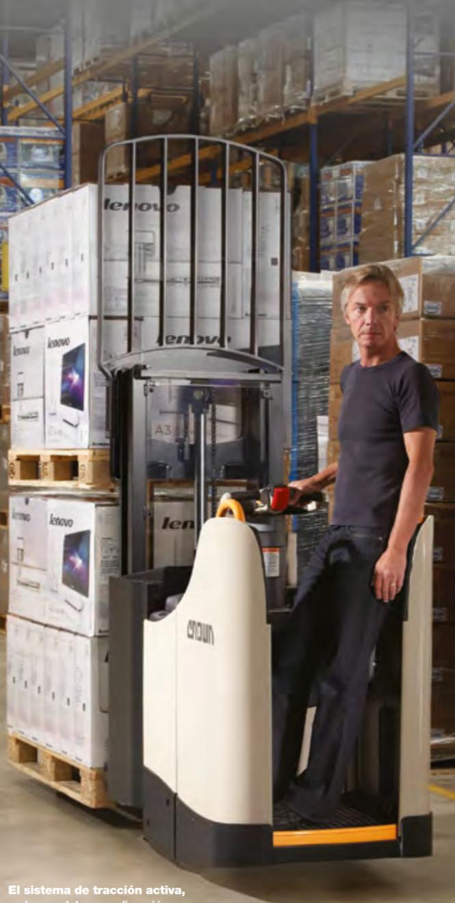
El sistema de tracción activa, en los modelos con dirección eléctrica, se caracteriza por un innovador conjunto electrónico e hidráulico que adapta la presión de la rueda motriz en función de la distribución de la carga, la velocidad, la aceleración y el frenado.
