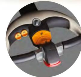
**El timón X10<sup>®</sup> de aluminio fundido** también contribuye a la durabilidad del conjunto y combina suavidad y precisión en el posicionamiento de pallets mediante funciones de elevación y descenso proporcionales.
