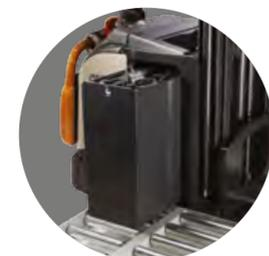
**El compartimento de la batería está diseñado** para facilitar la extracción lateral y agilizar su intercambio.
