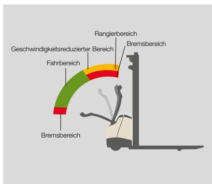
Al entrar en la zona de **anulación de freno con control de velocidad**, la velocidad de desplazamiento en la dirección de las horquillas se reducirá automáticamente a 1,5 km/h sin necesidad de parar ni de que el operario ejecute ninguna otra orden.
