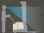
Gracias a la cubierta inclinada y de bajo nivel de la unidad de tracción y a la amplia visibilidad que aporta el diseño del mástil, las puntas de las horquillas se ven a la perfección en el momento de recoger y ubicar palés.
