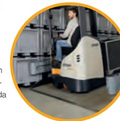
**Retención en rampa:** mantiene la carretilla en posición de parada en rampas o estanterías «push-back» hasta que se da una orden de desplazamiento.
