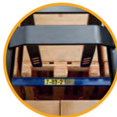
**Guía láser para horquillas:** opción para posicionar fácilmente las horquillas en altura para mejorar la precisión y la productividad.
