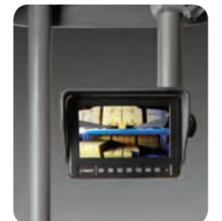
La opción de colocar una cámara en las horquillas o en el mástil facilita aún más la manipulación y el posicionamiento óptimos de la carga.
