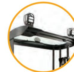
**Luces de trabajo:** las luces delanteras y traseras optativas ofrecen visibilidad extra para los operarios y los peatones.
