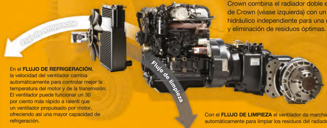
En el **FLUJO DE REFRIGERACIÓN**, la velocidad del ventilador cambia automáticamente para controlar mejor la temperatura del motor y de la transmisión. El ventilador puede funcionar un 30 por ciento más rápido a ralentí que un ventilador propulsado por motor, ofreciendo así una mayor capacidad de refrigeración.
