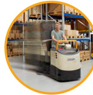
**La reducción de la velocidad en giros**, dependiendo del peso en las horquillas y del ángulo de la dirección, contribuye a optimizar la seguridad y el rendimiento.
