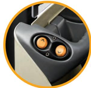
**Los botones opcionales de elevación/descenso** sobre el respaldo ofrecen mejor visibilidad dentro y fuera de la carretilla para la manipulación de cargas.
