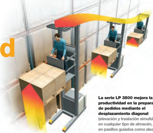
La serie LP 3500 mejora la productividad en la preparación de pedidos mediante el desplazamiento diagonal (elevación y traslación simultáneas) en cualquier tipo de almacén, tanto en pasillos guiados como aleatorios. La velocidad se regula automáticamente en función de la altura de la plataforma y del ángulo de la rueda directriz.
