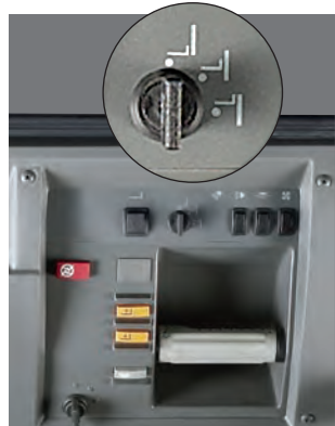
Llave de selección de zona Permite seleccionar tres límites de elevación preestablecidos
