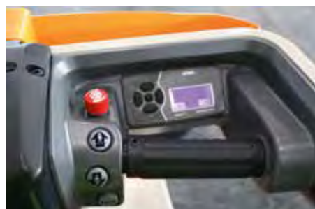
03 Los mandos para la velocidad de desplazamiento y para la plataforma de trabajo se encuentran en el lado derecho del compartimento del operario
