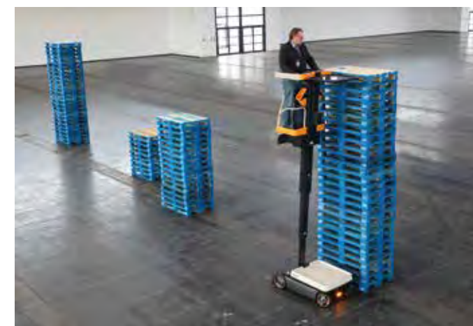
01 La plataforma de trabajo se puede elevar hidráulicamente hasta una altura de 2.995 mm
