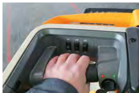
04 La mano izquierda se utiliza para dirigir el vehículo, ajustar la altura de la bandeja de carga, activar el modo «superlento» y controlar las luces de trabajo
