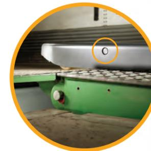
**El sistema de elevación por «tirantes»** (solo algunos modelos) coloca el eje de pivotación en el punto más alto posible, evitando así roturas y desgastes causados por suelos irregulares.
