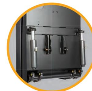
**Los dos cilindros de elevación** (solo algunos modelos) unidos por una barra de torsión de alto rendimiento aseguran una elevación equilibrada en la manipulación de cargas descentradas.
