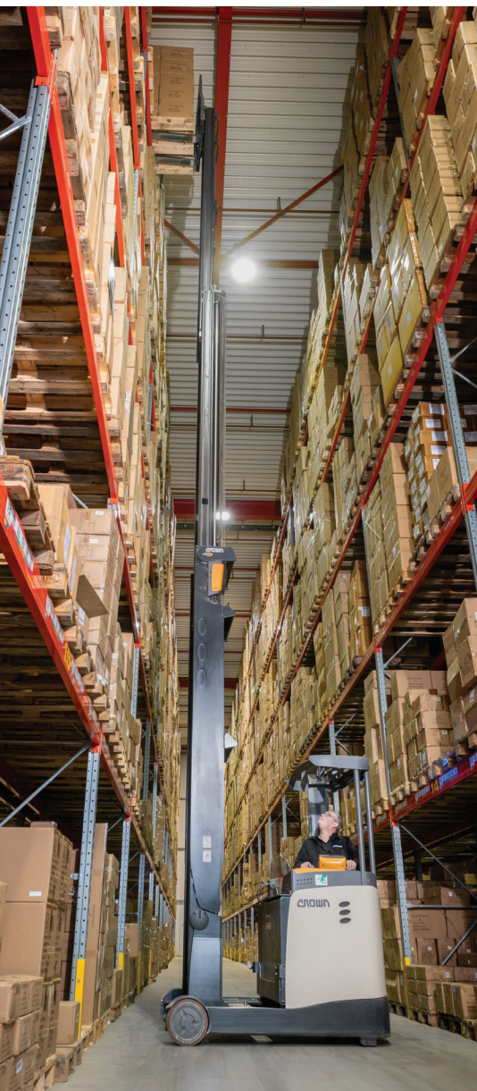
La tecnología Xpress Lower duplica la velocidad de descenso, aumentando así la productividad en el almacén.
