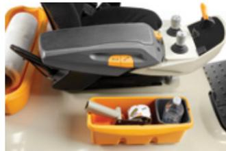
■ **Se puede colocar una bandeja de almacenamiento magnética** para piezas pequeñas y piezas en varios lugares del montacargas. También hay otros accesorios opcionales de Work Assist de Crown que se pueden ubicar en los postes de la protección superior de la cabina del operador para que se los pueda alcanzar con facilidad.
