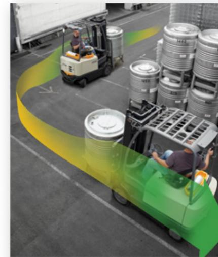
■ **El control de la velocidad de desplazamiento y de las curvas** limita de manera automática la velocidad de desplazamiento durante los giros en función del peso de la carga, la altura de levante y el ángulo de giro.
