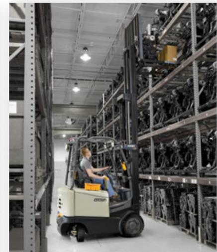
■ **El enclavamiento de la inclinación** disminuye el riesgo de vuelco al impedir que las horquillas y el mástil se levanten por encima del levante libre cuando se inclinan hacia delante más de dos grados.
