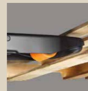
El perfil de la punta de las horquillas redondeada para facilitar la entrada en los pallets, y un diseño cerrado que las hace más fuertes. Además, el diseño de la punta de las horquillas impide que se acumule basura.
