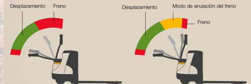
Crown ofrece a los operadores lo mejor de ambos mundos: en el **modo de funcionamiento normal**, una amplia zona de frenado garantiza que el equipo pueda pararse fácil y rápidamente en condiciones normales. Al trabajar en espacios reducidos, el **modo de anulación del freno** permite colocar el manubrio de control en posición casi vertical y activar la tracción a velocidad lenta para poder colocar la carga con precisión.
