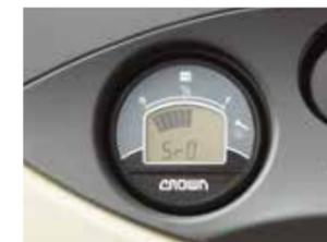
El display estándar muestra los códigos de falla para poder identificar sin problemas las fallas del sistema durante la operación o el encendido del equipo. No más suposiciones, toda la información está en el display.
