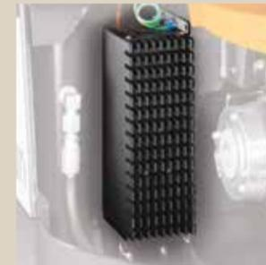
El cargador integrado sellado prácticamente elimina el acceso de contaminación que puede resultar en daños futuros. Además, el cargador está diseñado para funcionar sin un sistema de ventilación separado para mejorar su confiabilidad.
