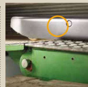
El eje del mecanismo de levante elevación de la serie WP 3000 está situado en el punto más alto posible y está diseñado específicamente para proteger las horquillas. De esta manera, eliminan las frecuentes reparaciones por daños en el eje de elevación debido al contacto constante con los muelles de carga, pallets y suelos irregulares.
