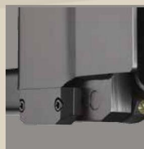
Bloques de desgaste de acero para los talones de las horquillas actúan como el primer punto de contacto cuando la distancia de claridad con el suelo es excedida. Estos bloques de desgaste protegen la estructura inferior del equipo al pasar por superficies irregulares, muelles de carga con bordes afilados o plataformas elevadoras.
