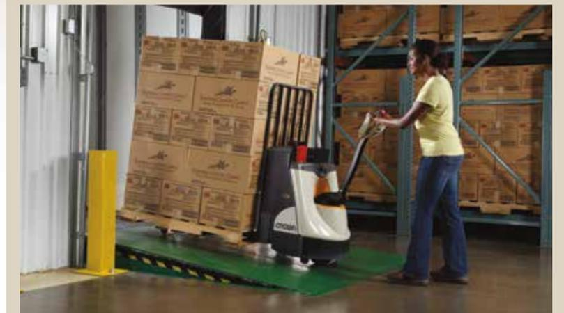
**El sistema de retención en rampa de Crown mejora el control y la confianza del operador**, ya que reduce al mínimo la posibilidad de que el equipo se mueva accidentalmente hacia atrás cuando está parado en una pendiente. Asimismo, ofrece velocidades constantes en las rampas, independientemente que vaya con o sin carga.
