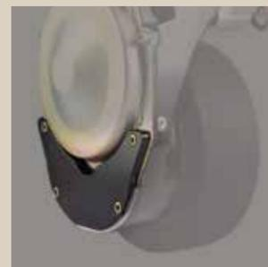
Se ha añadido un protector de acero de alto rendimiento en la parte exterior de la caja de engranajes para evitar impactos de las horquillas.
