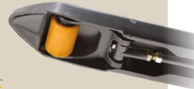
Un sistema de acoplamiento de las horquillas asegura un alineamiento apropiado de las ruedas de carga, lo cual extiende la vida útil de las ruedas, mejora la entrada al pallet e incrementa la estabilidad del equipo. El resultado son menos gastos en mantenimiento y menos daños en los pallets.
