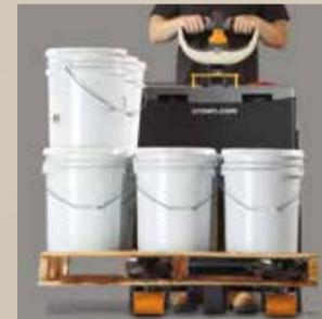
Diferente a otras marcas, para entregar la mejor estabilidad en la industria, el diseño de la WP 3000 combina una barra de torsión para uso pesado con dos cilindros de levante. Como resultado de este sistema de estabilidad, los operadores manipulan cargas disperejas confiablemente y trabajan fácilmente sobre superficies irregulares o en pendientes, o bien al pasar por hoyos en el piso, muelles de carga y drenajes.
