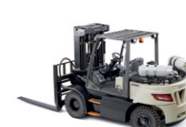
Serie C-G, modelos 60-70 Ruedas: neumáticos Potencia: combustión interna (LPG) Capacidad de carga: de 6,000 a 7,000 kg Altura de levante: de 3,000 a 6,050 mm
