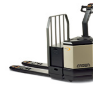
Serie PW 3500 Transpaleta de operador a pie Capacidad de carga: 2,721 y 3,628 kg
