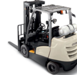
Serie C-G, modelos 35-55 Ruedas: cushion Potencia: combustión interna (LPG) Capacidad de carga: de 3,500 a 5,500 kg Altura de levante: de 2,750 a 7,000 mm
