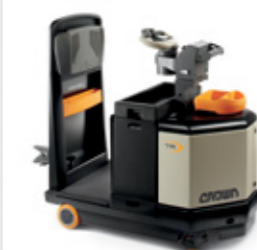
Serie TR 4500 Tractor de remolque Capacidad de carga rodante: 4,500 kg
