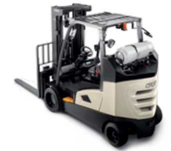
Serie C-G, modelos 35-55 con Box Car Ruedas: cushion Potencia: combustión interna (LPG) Capacidad de carga: de 3,500 a 5,500 kg Altura de levante: de 2,750 a 7,000 mm
