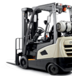
Serie C-G, modelos 15-20 Ruedas: cushion Potencia: combustión interna (LPG) Capacidad de carga: de 1,500 a 2,000 kg Altura de levante: de 1,980 a 6,000 mm
