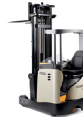
Serie ESR 5200 Capacidad de carga: de 1,400 a 2,000 kg Altura de levante: de 2,760 a 13,000 mm
