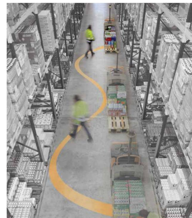
En el caso de las aplicaciones de picking de bajo nivel, el sistema **QuickPick™ Remote** utiliza tecnología inalámbrica para actualizar el montacargas de manera remota. QuickPick Remote reduce la cantidad de veces que el operador sube y baja del montacargas, esto ayuda mejorar la seguridad, reducir la fatiga del operador y aumentar la productividad, lo que ahorra hasta cinco segundos por recogida.
