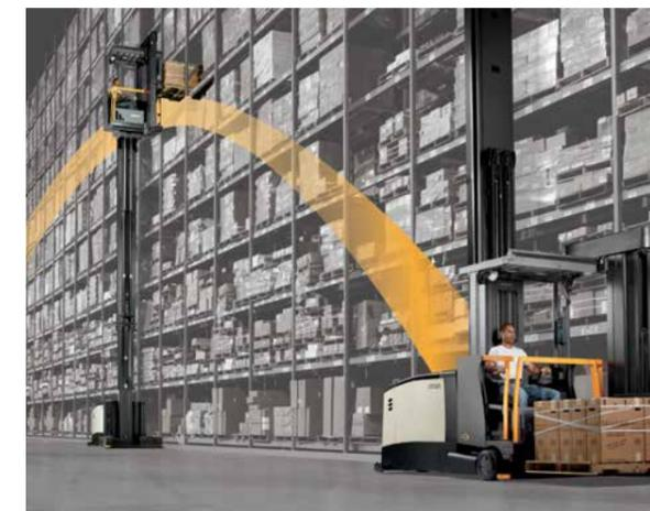
**El sistema de posicionamiento automático**, disponible en los modelos TSP, mejora la consistencia y la precisión de recogida en aplicaciones de pasillos muy angostos, aumenta la productividad ya que elige una ruta más eficiente hacia la siguiente posición de recogida. Incluye la función de limitación automática.
