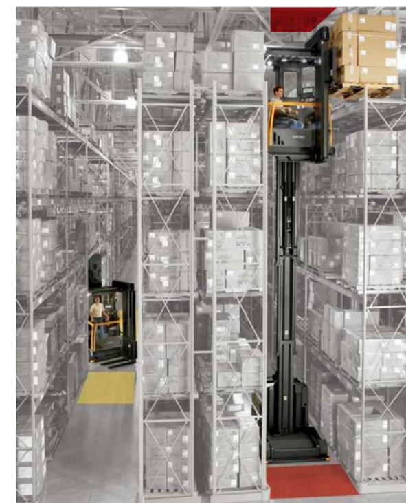
**La función de Limitación Automática**, disponible en los modelos TSP, ayuda en la promoción de la seguridad, ya que reduce de manera automática la velocidad de desplazamiento, parando o restringiendo la altura del equipo dentro del pasillo muy angosto en base a la ubicación del equipo.
