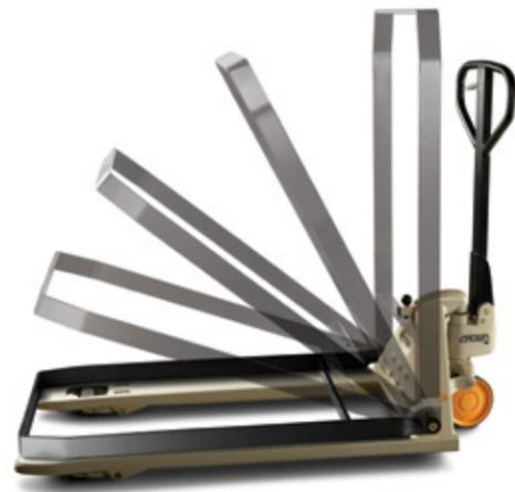
**El adaptador de pallet** aumenta la altura colapsada hasta 140 mm para facilitar la manipulación de skids. La altura en la posición superior aumenta hasta los 267 mm. El adaptador se enclava en posición vertical para las tareas de manipulación de pallets.
