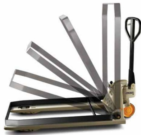
O adaptador de paletes aumenta a altura abaixada para 140 mm, permitindo o ajuste do paleta. A altura levantada aumenta para 267 mm. O adaptador trava na posição vertical para tarefas de movimentação de paletes.
