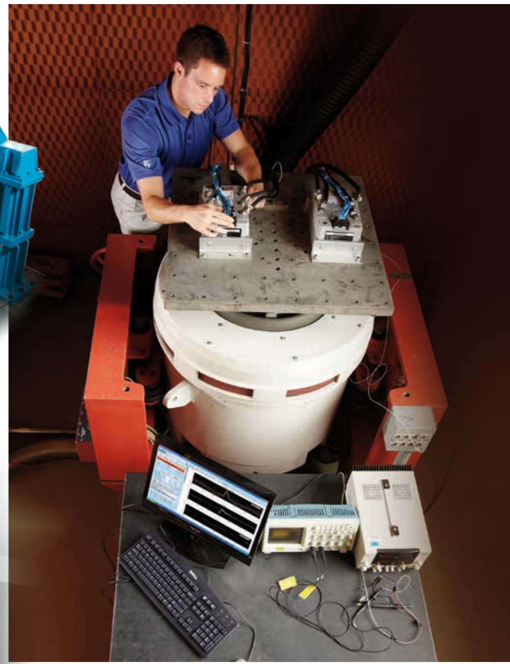
▲ Una prueba electrodinámica de movimiento aplica 8.000 libras de fuerza al producto para asegurar que soporta repetidos movimientos y vibraciones.
