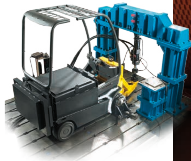
▲ Pruebas en la estructura verifican la durabilidad de la misma.
