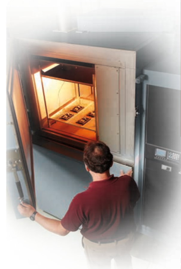
▲ Los componentes eléctricos de nuestros equipos se ponen a prueba de -40° a 85°C para verificar que funcionan a temperaturas extremas.
