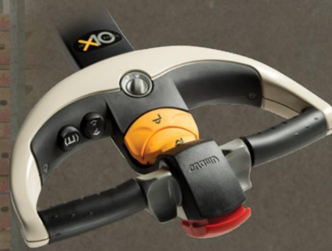
El diseño ergonómico flexible del **X10™ Handle** permite que el operador acceda a los controles de cada lado de la unidad de potencia, lo que despeja la vista y mejora la maniobrabilidad.
