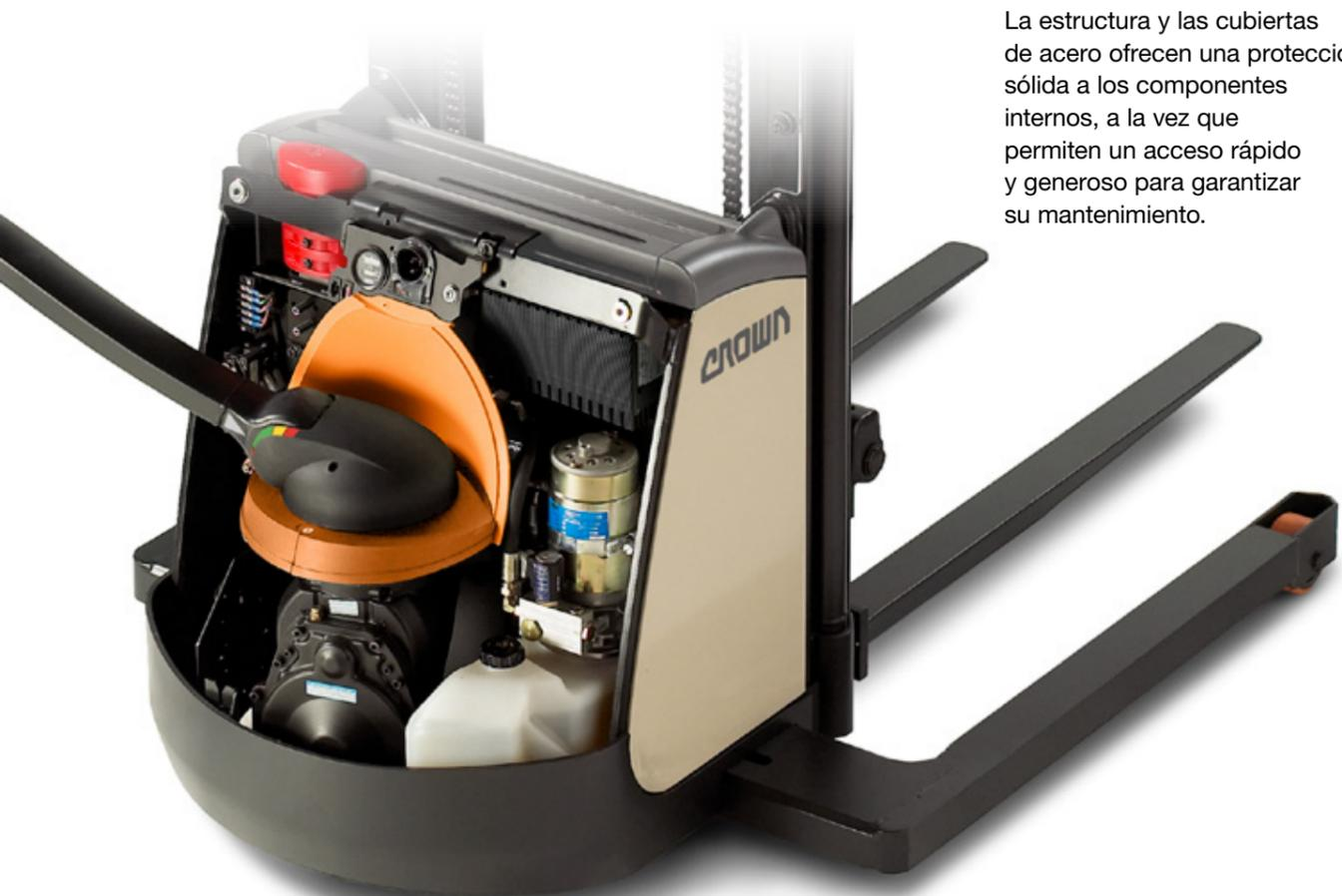
La estructura y las cubiertas de acero ofrecen una protección sólida a los componentes internos, a la vez que permiten un acceso rápido y generoso para garantizar su mantenimiento.
