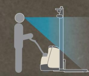
La cubierta inclinada de la unidad de potencia de baja altura y el diseño del mástil abierto ofrecen una excelente visibilidad de la punta de las horquillas para que el pallet entre y salga.
