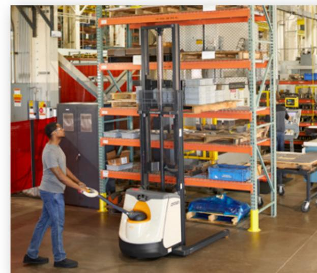
Los operadores consideran que los apiladores con estabilizadores son fáciles de usar para apilar elementos de manera vertical en un sistema de estantería. La facilidad de la maniobrabilidad simplifica el posicionamiento y la colocación de la carga.
