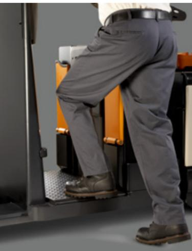
La **plataforma de la serie PC 4500 se detiene en la altura configurada cada vez** que levanta las horquillas para que los operadores tengan una altura de peldaño uniforme.
