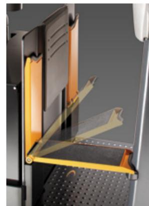
**Según los estudios llevados a cabo por Crown, el peldaño de recogida de segundo nivel de la serie PC 4500 duplica la cantidad de recogidas que el operador puede alcanzar con facilidad.** El diseño desplegable les ofrece a los operadores una pisada segura y rápida, y extiende la zona de recogida cómoda hasta dos pies.
