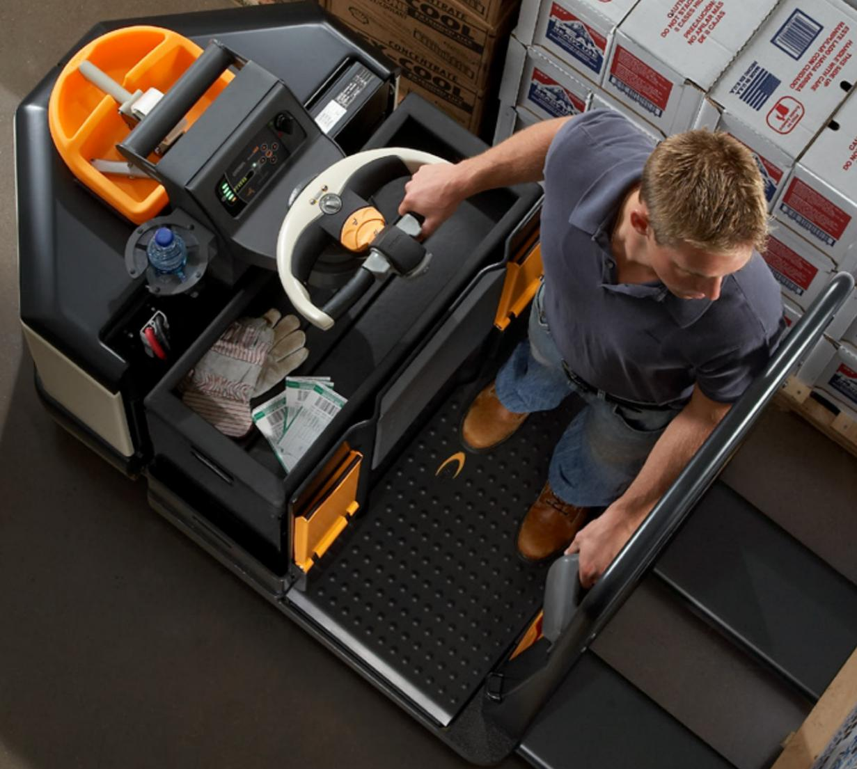
La dirección asistida electrónica le permite al operador trabajar en una postura lateral cómoda para ingresar pallets o maniobrar en espacios congestionados. Las opciones de Work Assist™ como los peldaños de recolección en el segundo nivel, el portavasos y el módulo de almacenamiento de batería favorecen la eficiencia y productividad del operador.
