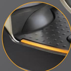
**Interruptor de seguridad Entry Bar™** – ayuda a mejorar la seguridad del operador cuando se complementa con el pedal del freno y de presencia. Si el operador coloca un pie sobre el interruptor Entry Bar, el montacargas se detiene automáticamente y suena una alarma.
