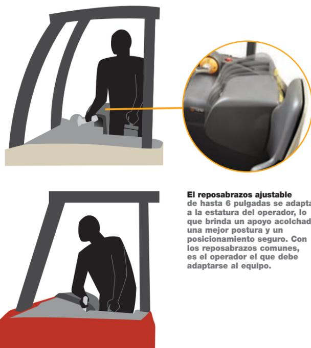
El reposabrazos ajustable de hasta 6 pulgadas se adapta a la estatura del operador, lo que brinda un apoyo acolchado, una mejor postura y un posicionamiento seguro. Con los reposabrazos comunes, es el operador el que debe adaptarse al equipo.
