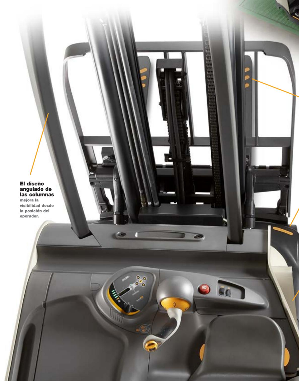
El diseño angulado de las columnas mejora la visibilidad desde la posición del operador.
