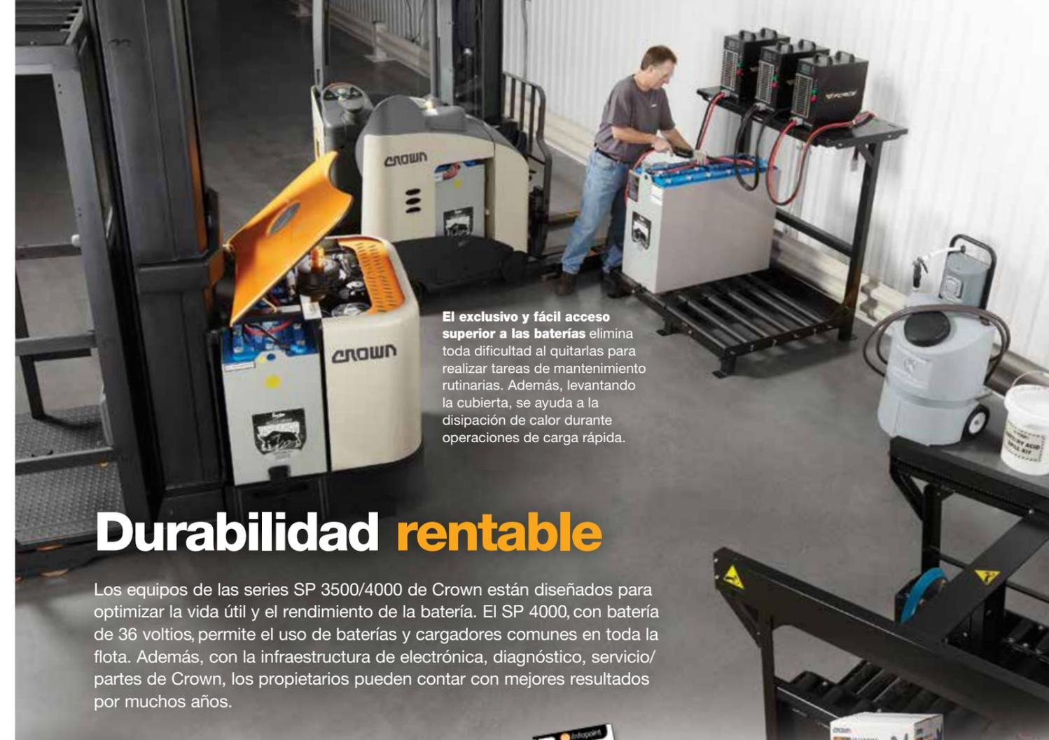
**El exclusivo y fácil acceso superior a las baterías** elimina toda dificultad al quitarlas para realizar tareas de mantenimiento rutinarias. Además, levantando la cubierta, se ayuda a la disipación de calor durante operaciones de carga rápida.
