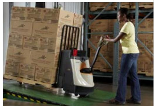
Crown les proporciona a los operadores el control para manejar la tarea en cuestión. Al maniobrar una carga, el control de velocidad en posición les permite a los operadores mover el manubrio en posición casi vertical mientras ocupan la tracción a velocidad lenta. Al operar en espacios reducidos con el manubrio en posición vertical total, la función de mando vertical permite posicionar de forma minuciosa.
