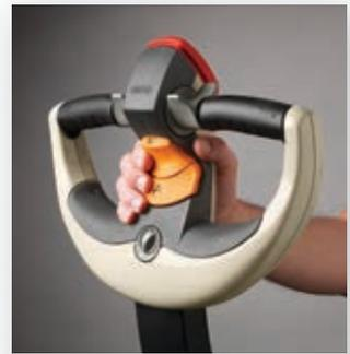
**Posición vertical** El manubrio de control X10 incorpora una base de control para elevar y descender el manubrio cuando está en posición vertical.
