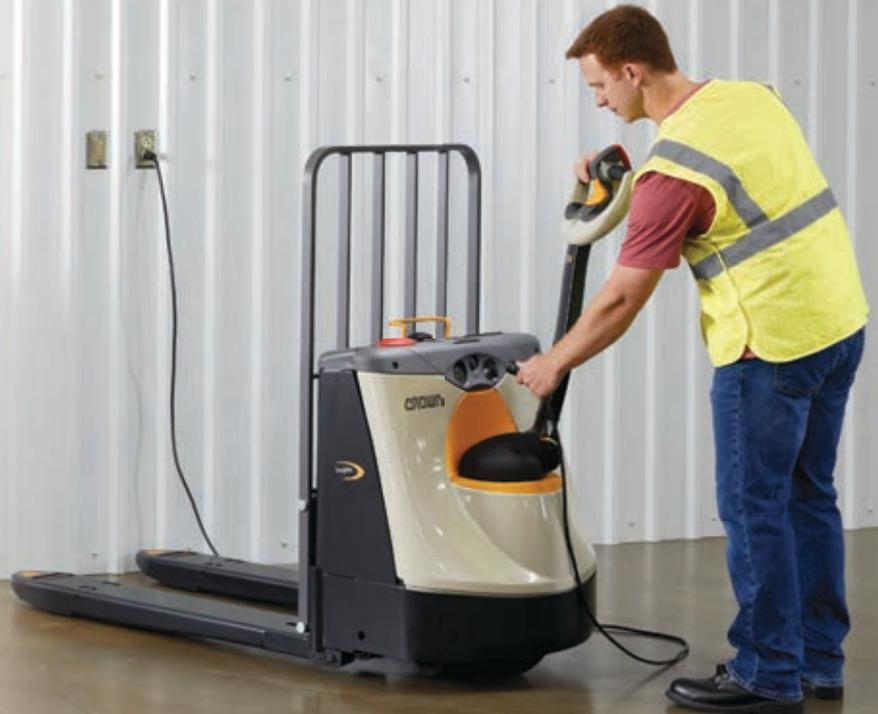
El **cargador incorporado** sellado es tan versátil que trabaja con baterías de ion-litio y de ácido-plomo. Además, prácticamente elimina la entrada de contaminación que puede causar fallas.
