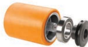
**La serie WP 3200 de Crown cuenta con un diseño de rueda de carga que incorpora un protector contra residuos.** Esto evita que los residuos como el material plástico de embalaje, las cintas de plástico y la cinta adhesiva de embalar se acumulen alrededor del eje, lo que podría causar fallas de rodamiento y en las ruedas.
