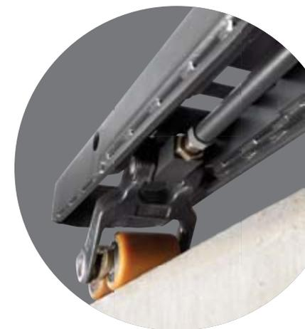
**Las horquillas de una pieza, de acero doblado en frío y de alta resistencia**, tienen forma de C y están reforzadas en los puntos críticos. Las varillas ajustables de elevación tiran del eje, absorbiendo los impactos y aportando mayor protección al conjunto.
