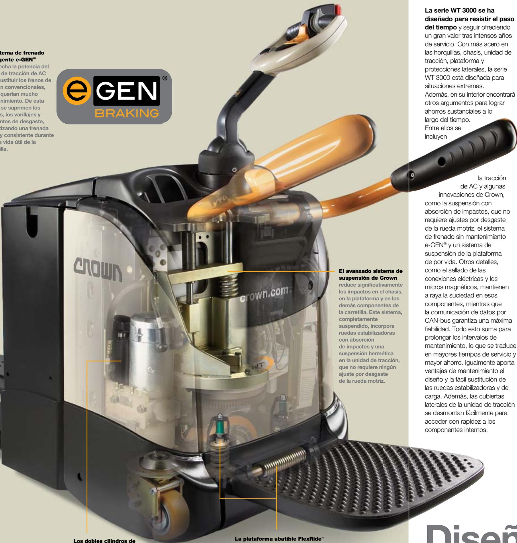
**El avanzado sistema de suspensión de Crown** reduce significativamente los impactos en el chasis, en la plataforma y en los demás componentes de la carretilla. Este sistema, completamente suspendido, incorpora ruedas estabilizadoras con absorción de impactos y una suspensión hermética en la unidad de tracción, que no requiere ningún ajuste por desgaste de la rueda motriz.
