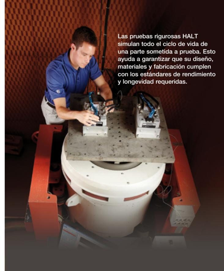
Las pruebas rigurosas HALT simulan todo el ciclo de vida de una parte sometida a prueba. Esto ayuda a garantizar que su diseño, materiales y fabricación cumplen con los estándares de rendimiento y longevidad requeridas.
