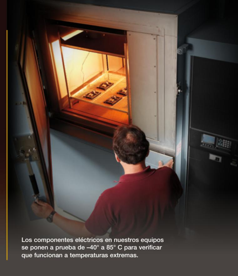
Los componentes eléctricos en nuestros equipos se ponen a prueba de  $-40^{\circ}$  a  $85^{\circ}$  C para verificar que funcionan a temperaturas extremas.
