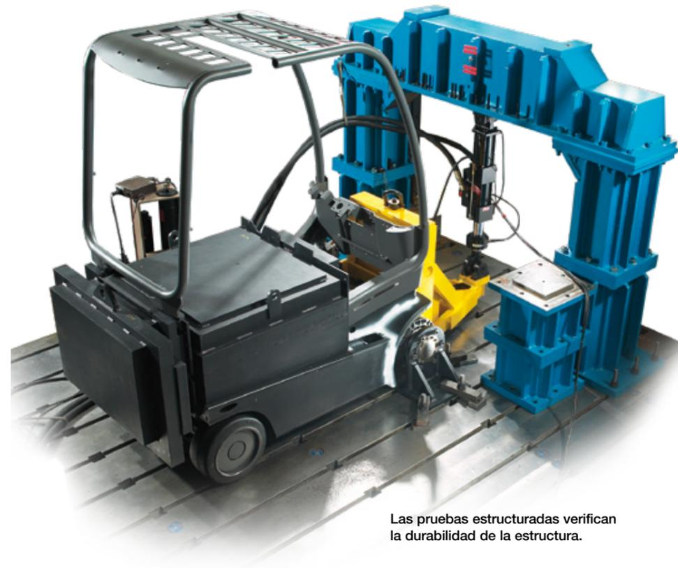
Las pruebas estructuradas verifican la durabilidad de la estructura.
