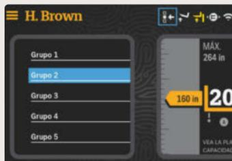
Para seleccionar una altura de estantería predeterminada, pulse el botón de un solo toque o el selector de altura de estantería en la almohadilla de control del reposabrazos. La altura de estantería seleccionada se aumenta y se muestra en blanco.
