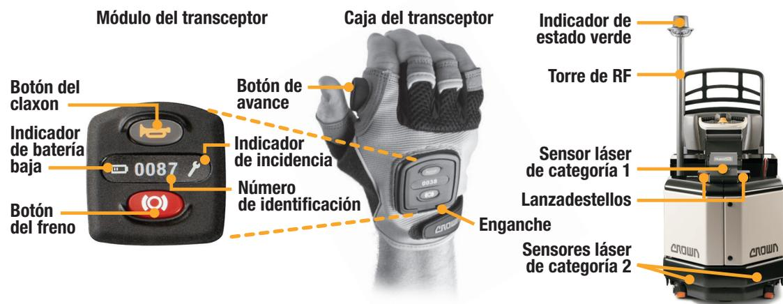
Al principio del turno, monte un transceptor cargado en la caja y emparejelo con la carretilla.
