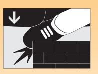
Un pié o una mano atrapada entre el montacargas y una pared, poste u otro objeto fijo, sería aplastado o incluso seccionado.
