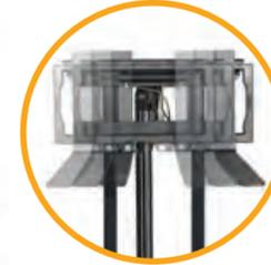
**5e fonction hydraulique** – option pour contrôler les accessoires tels que les positionneurs de fourches avec tablier à déplacement latéral ou les pinces pour répondre aux exigences spécifiques de l'application.
