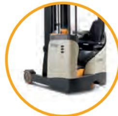
**Longerons étroits** – des charges de 1000 mm de largeur maximum peuvent être accommodées entre les longerons sans augmenter la largeur totale du chariot.
