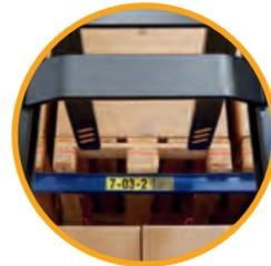
**Guide laser des fourches** – option pour positionner facilement les fourches en hauteur, pour une précision et une productivité accrues.
