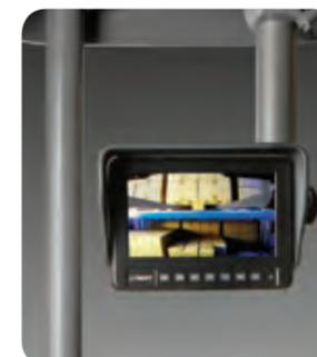
Les caméras en option pour les fourches ou le mât viennent encore optimiser la manutention et le positionnement des charges.
