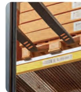
L'assistance à l'inclinaison des fourches en option sur la série ESR compense la flexion du mât et du tablier porte-fourches et met automatiquement les fourches de niveau par rapport au sol pour un positionnement plus précis.
