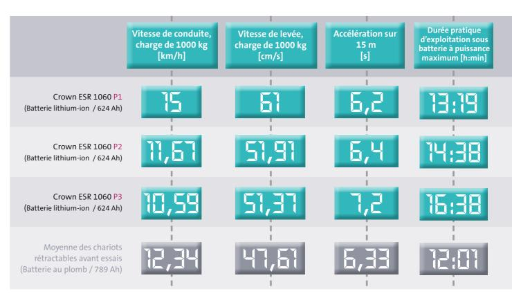
hauteurs de mât jusqu'à 13,560 mètres. Notre choix pour les essais s'est porté sur le chariot ESR 1060 qui offre une capacité de levée de 1,6 tonne, une hauteur de mât de 6,840 m et est équipé d'une batterie lithium-ion de 48 V/468 Ah.
